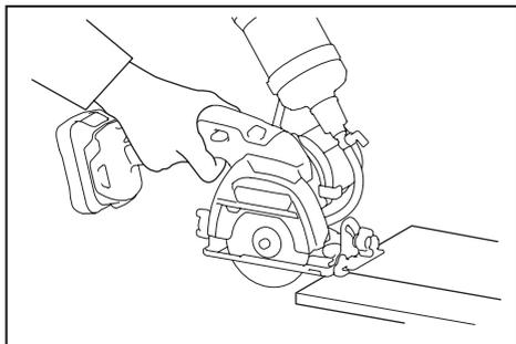
Sostenga la herramienta con firmeza. Coloque la placa de la base sobre la pieza de trabajo que va a cortar sin que la rueda haga contacto alguno.
