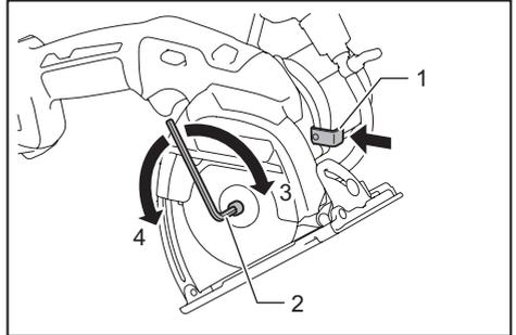
► 1. Bloqueo del eje 2. Llave hexagonal 3. Apretar 4. Aflojar
