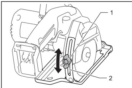
► 1. Tornillo de fijación 2. Guía de profundidad
